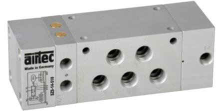
Diese Zwei-Signal-Steuerung hat außer den beiden Signaleingängen bei 12 noch den Signalanschluss 14. Signal auf 14 schaltet die Zwei-Signal-Steuerung wie ein normales 5/2-Wege-Ventil.
